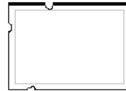
图10-2 深度 \le 0.2\text{mm} 且宽度 \le 0.5\text{mm} 的 缺角或崩边每边最多一个
